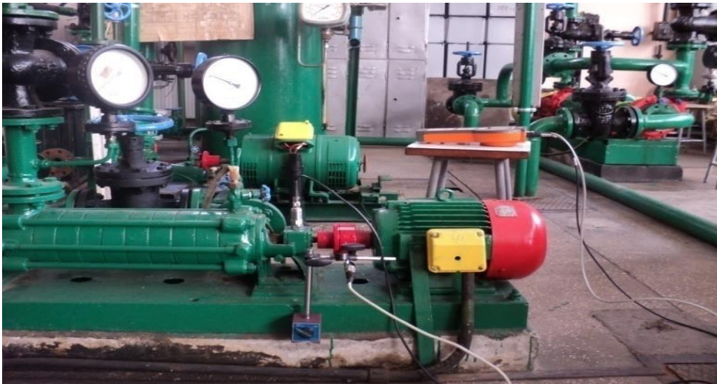
Fig 3.1 Standul experimental al testarii unei pompe centrifuge
