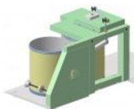
Fig.5. Mecanismul de schimbare automată a cănilor
