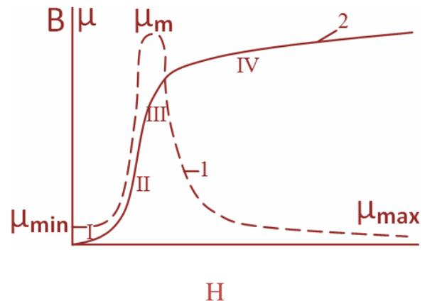
Figure 1. Dependencies  $\mu=f(H)$ - curve 1 și  $B=f(H)$ -curve 2 for magnetic materials
