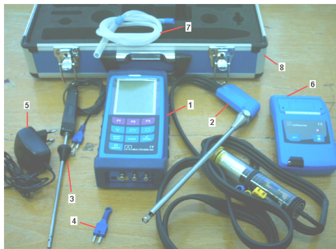
Fig. 2. Kitul de măsurare al analizorului de gaze de ardere Multilyzer N.G 1 – unitatea centrală, 2 – sondă de prelevare, 3, 4 – senzori de temperatură, 5 – adaptor de tensiune, 6 – imprimantă portabilă cu transmiterea datelor prin infraroșu, 7 – furtun de calibra în aer curat al aparatului, 8 – geantă de transport.
