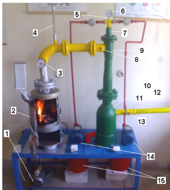
Fig. 1. Instalația pilot folosită la testarea sorbenților
