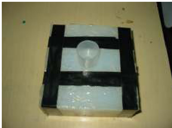
Figura 4. Matrița pregătită pentru turnare
