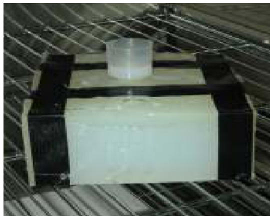
Figura 5. Matrița în cuptorul de polimerizare, pentru solidificarea piesei
