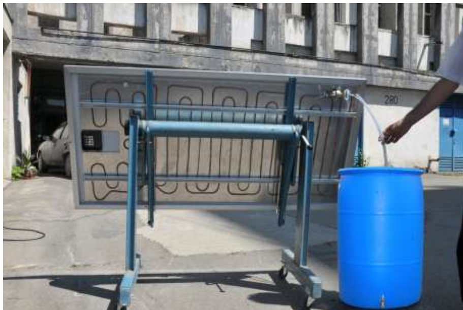
Figura 4. Sistemul de răcire pentru panoul PV
