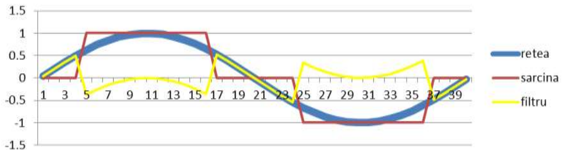
Figura 2. Cei trei curenti existenți în sistem (rețea, sarcină, filtru) Figure 2. The three currents in the system (grid, load, filter)
