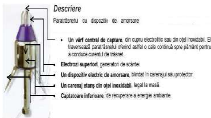
Figura 3. Precvectron 2 - PDA (Paratrăsnet cu dispozitiv de amorsare- Indelec-Franța)
