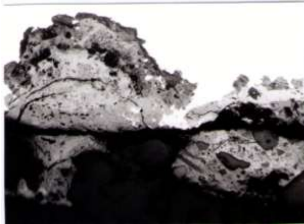
Imaginea 1. Coroziune inegală . Picture 1. Uneven corrosion.
