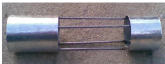
Fig.2. Construcția finală a armăturii metalice a unui sac filtrant
