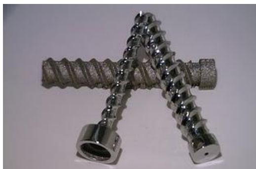
Figura 4. Piesa din spate este nefinisată. În plan apropiat este o piesă din oțel inoxidabil finisată prin metoda “optical finish”.
