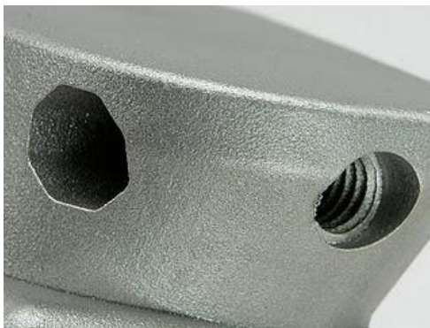
Figura 2. Piesă din oțel, finisată cu lovituri prin ciocănire.
