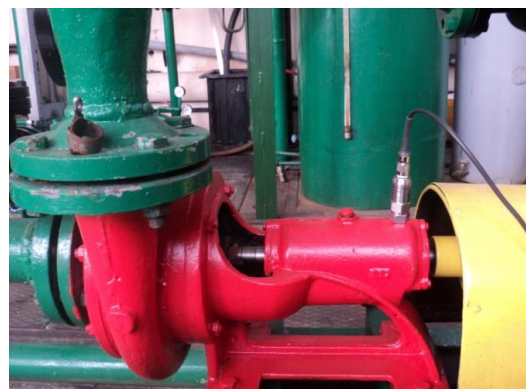
Fig. 5. Schema de amplasare a senzorilor de vibratii pe pompa monoetajata: M - motor electric de current continuu; Pr - presetupa; 1,2- lagare de rostogolire.
