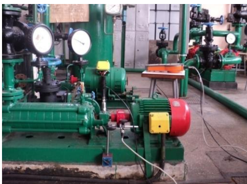
Fig. 3. Schema de amplasare a senzorilor de vibratii pe pompa multietajata orizontala cu zece rotoare: M - motor electric de current alternativ; PC- pompa centrifuga; 1,2 - lagare de rostogolire.
