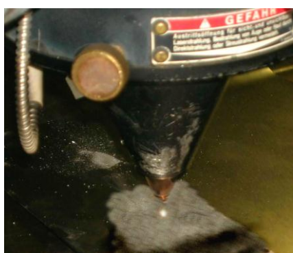
Fig. 1. Depunere pe suprafața unei bucăți material din OL 37 de grosime 4mm.
