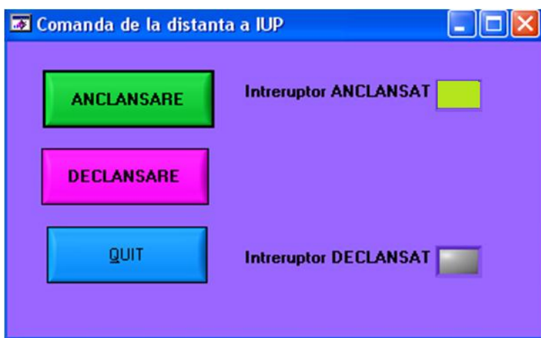
Figura 6. Interfața grafică de comandă de la distanță a întreruptorului în starea anclanșat Figure 6. The graphics interface remote control of switch for switched state
