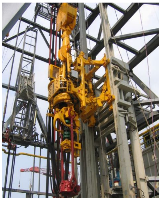
Figura 4 Sistemul TOP DRIVE
