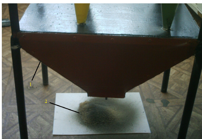
Fig. 6. Evacuarea pulberilor din buncărul multiciclonului experimental 1 – buncărul multiciclonului experimental; 2 – pulberi
